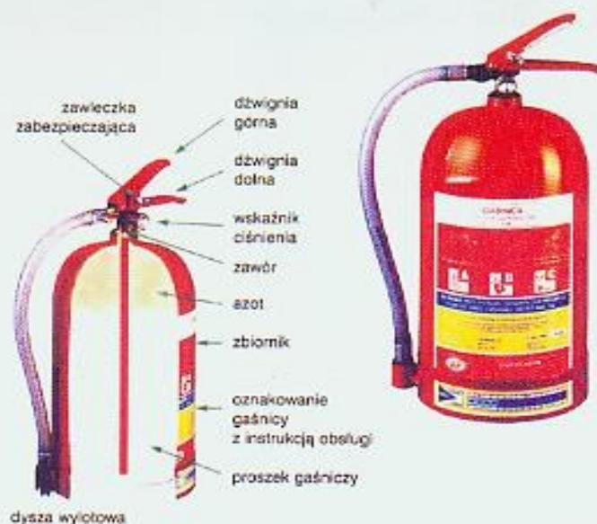
Rys. 1. Obsługa gaśnicy proszkowej GP-6
